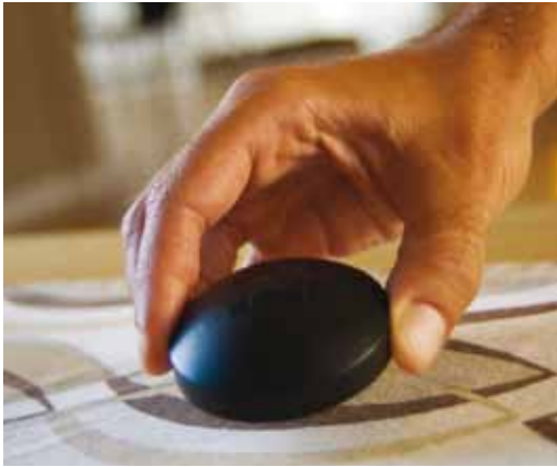
En radondosa används för att mäta radon.
